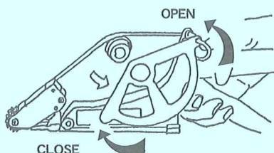
ラベルホルダーはOPENの方向に回すと手前に外れます。ラベルをセットして、ホルダーを元のCLOSEの位置に戻します。
