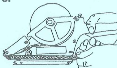
ラベルを透明なラベル押さえの下に通してから後方に折り返し、2で開けた底蓋を元の様に閉めます。
