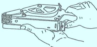
底蓋固定枠を矢印の方向に外し、底蓋を開けます。
